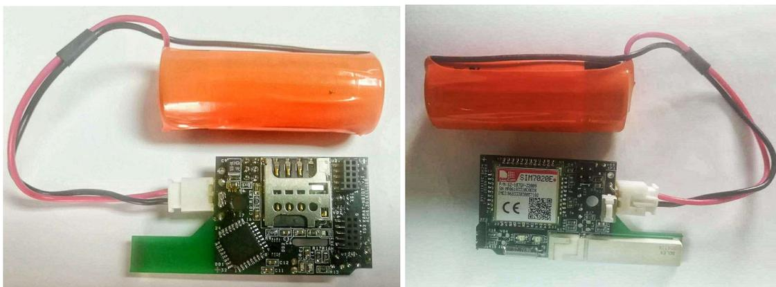
Рисунок 2. NB-модуль счетчика. Внешний вид
