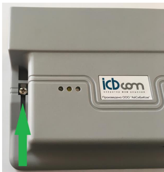
Рисунок 3 – Места для пломбировки крышки счетчика
