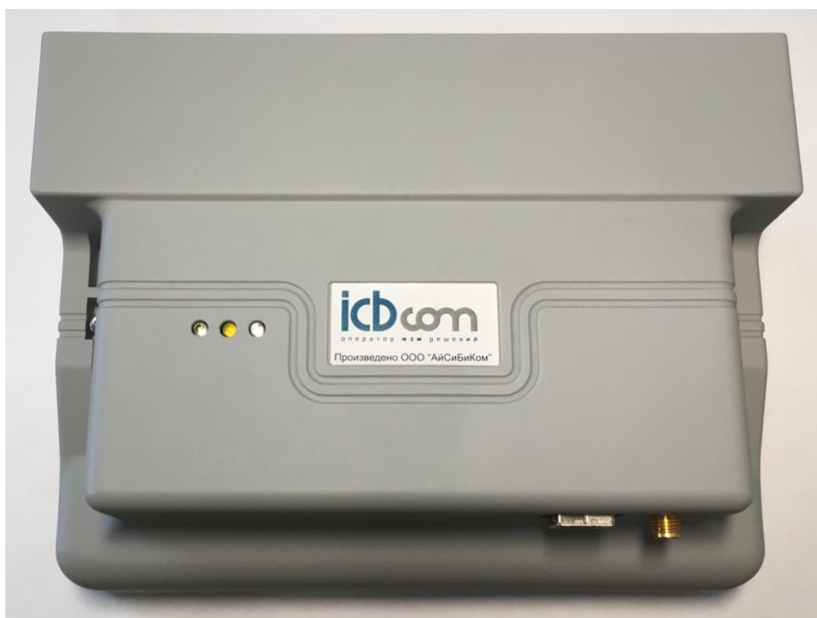
Рисунок 1 - Крышка ретрофит LoRaWAN для счетчика Меркурий М230
