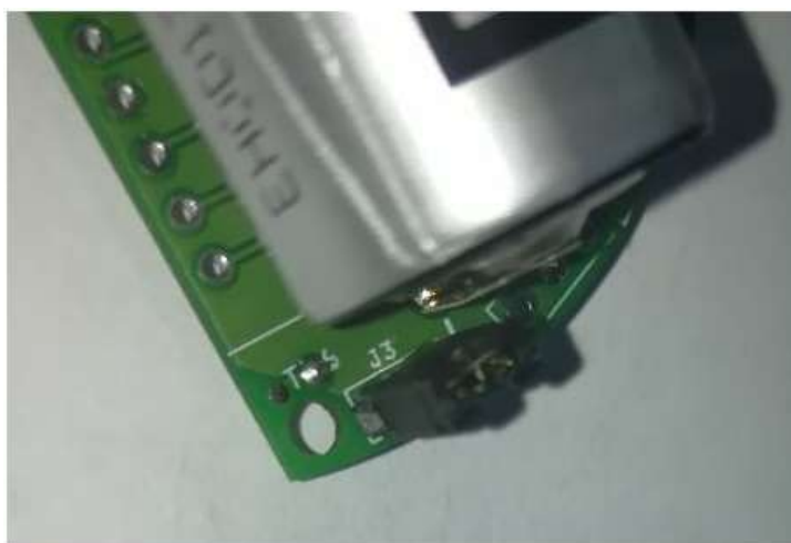
Рисунок 7 – установка джампера J3
