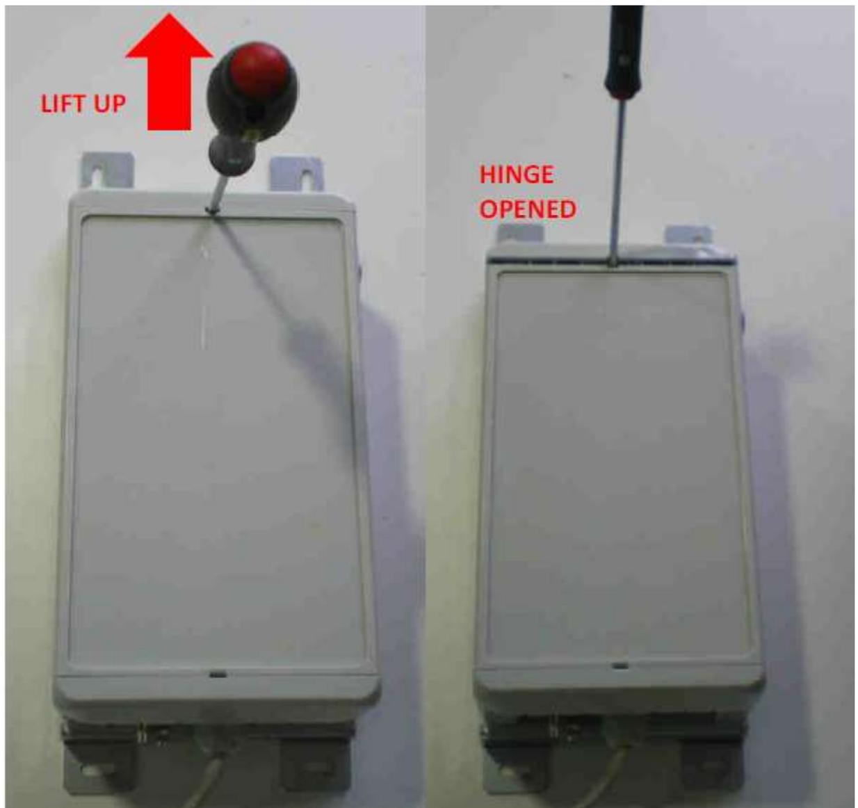
Рисунок 12 - Открытие корпуса с помощью отвертки
