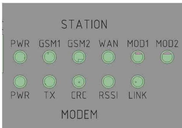
Рисунок 48 - Светодиодные индикаторы
